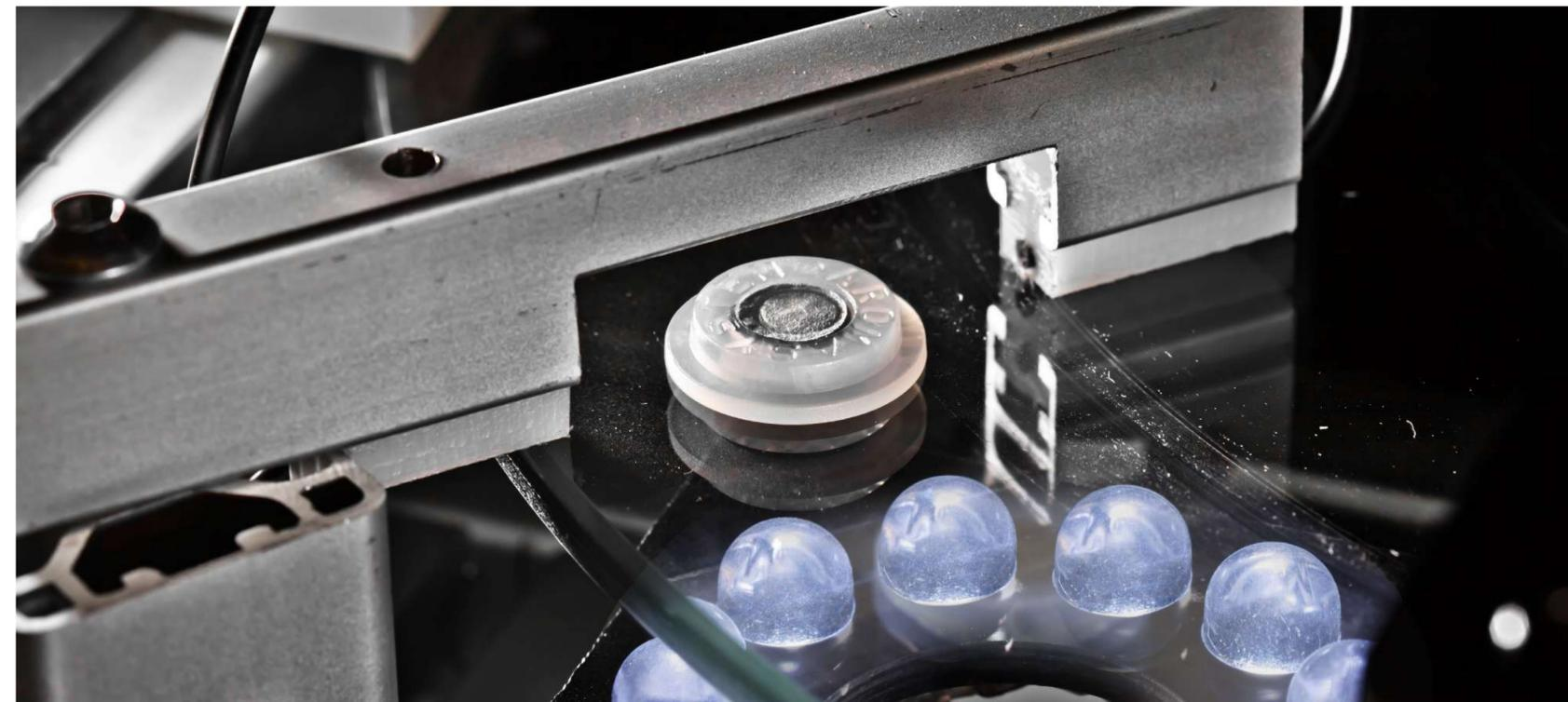
Dans les systèmes **AV65, AV67 et AV77**, les valves sont thermo-soudées **automatiquement**.
