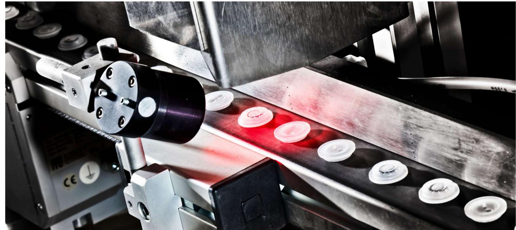
Un système de contrôle de forme, dimensionnel et optique avec scan 11 sur 100% des pièces est réalisé sur les chaînes d'assemblage des valves, afin de garantir une parfaite continuité de production et une sélection en temps réel des pièces non conformes. Un système de contrôle optique et instrumental offline est également utilisé, réalisé systématiquement dans les sites de production et dans différents laboratoires pour vérifier la fiabilité de l'évaluation, concernant:
