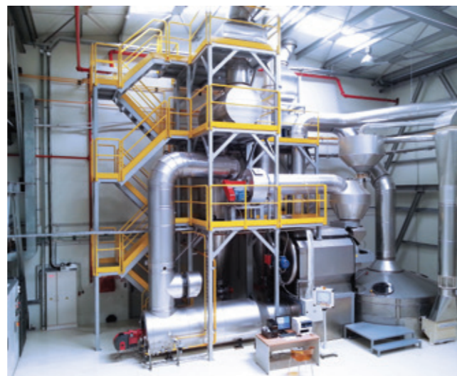
1. Torréfacteur. / Tostadora. 2. Torréfacteur avec chambre de combustion, brûleur de fumées et catalyseur. / Tostadora con cámara de combustión, quemador de humos y catalizador.
