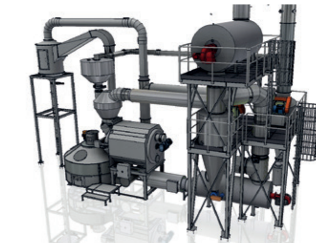
1. Brûleur de fumées positionné à dessus du torréfacteur. / Quemador de humos colocado en altura. 2. Brûleurs de fumées chaudes et froides. / Quemador de humos calor y frío.
